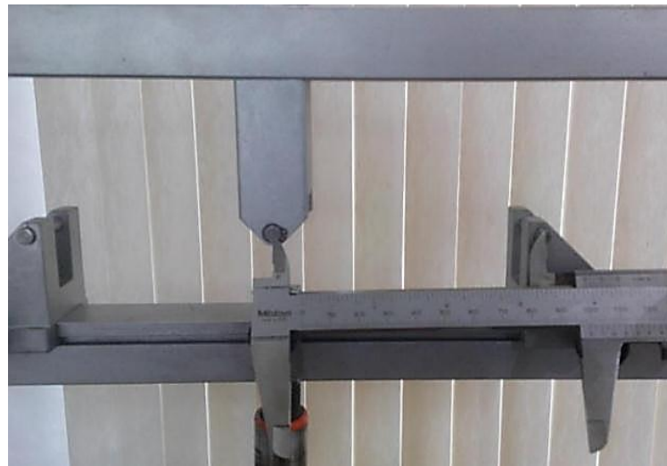
Figura 6. Ajuste de la distancia entre pernos.
