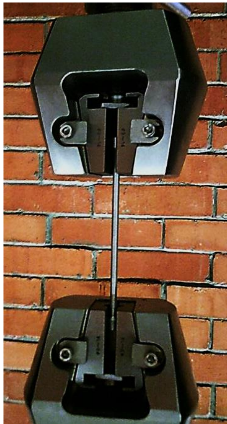
Figura 4. Probeta colocada en las mordazas.
