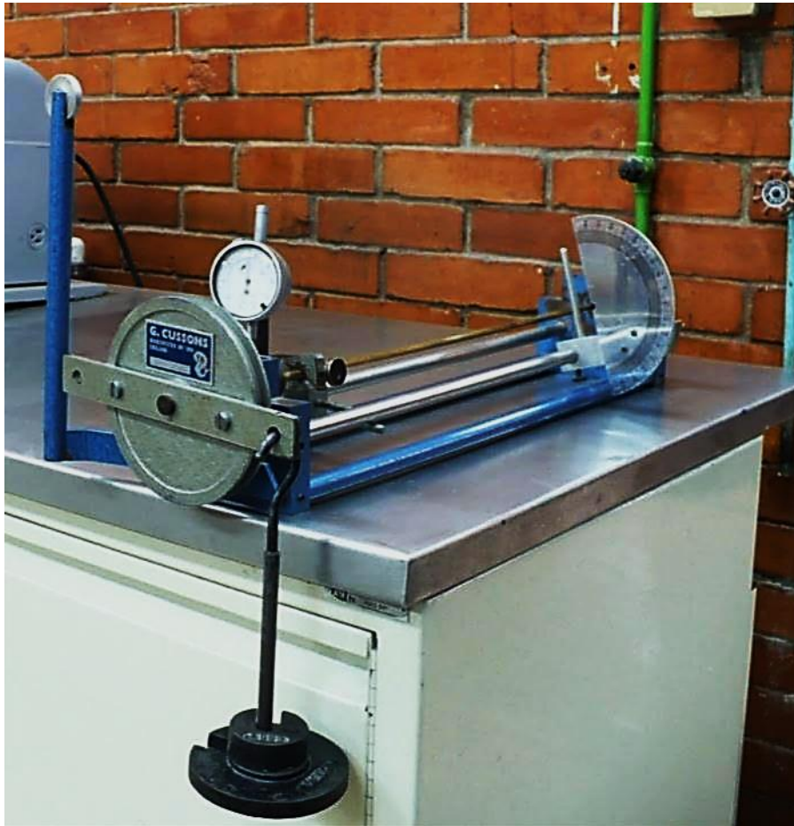
Figura 4. Aparato de torsión
