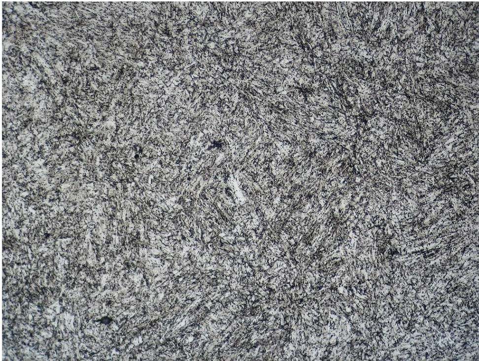
Figura 1. Micrografía de martensita revenida, 400x ataque químico con nital al 2%.
