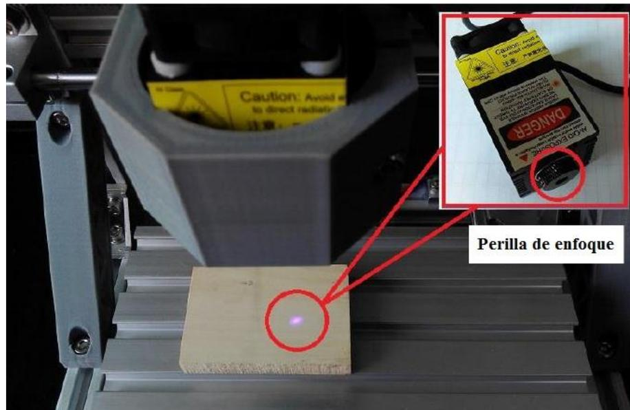
*Figura 9.2. Enfoque del módulo láser*
