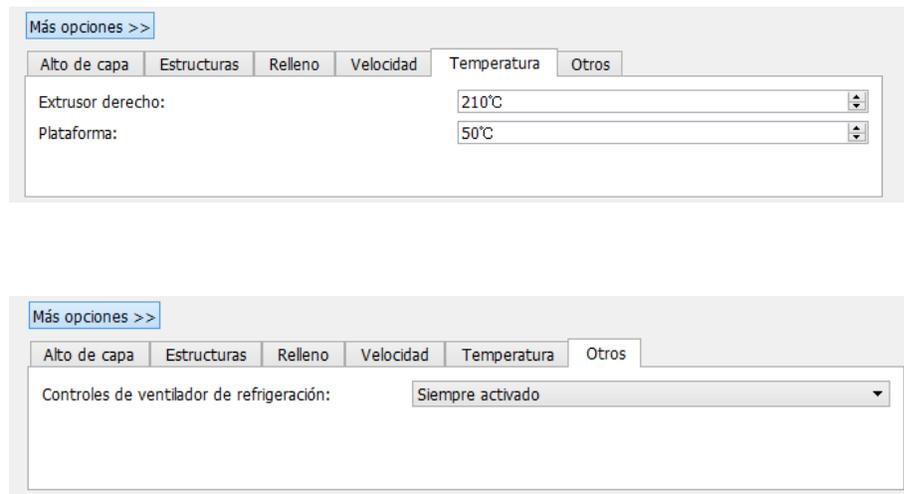
*Figura 8.6. Ajuste de configuraciones para la impresión del modelo 3D.*
