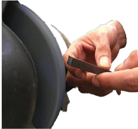
Figura 2.6. Posición para desbaste frontal
