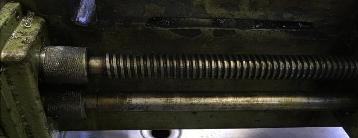
Figura 3.10. Tornillo sinfín y flecha del avance automático
