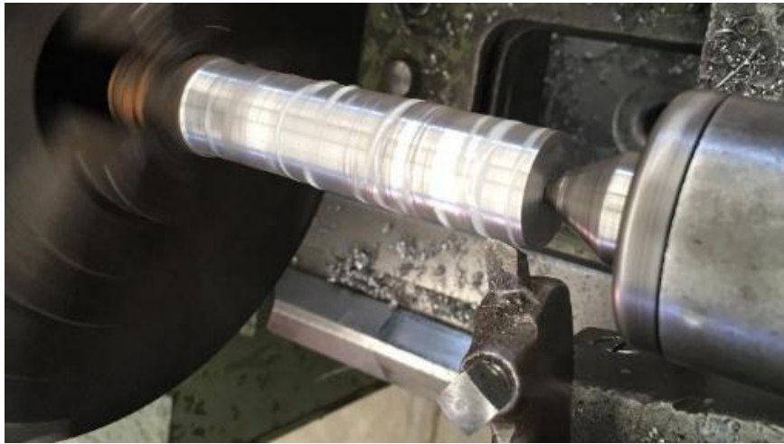
Figura 5.1. Maquinado de un cilindro con refrigerante
