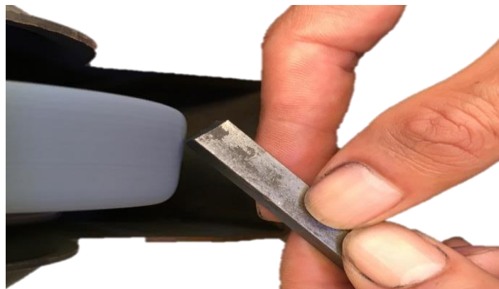
Figura 2.19. Posición para el primer contacto
