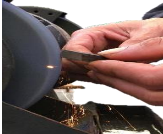
Figura 2.20. Desbaste para formar filo en V
