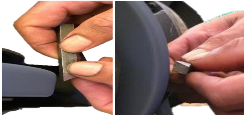
Figura 2.16. Desbaste cara superior del buril vista 1 y 2
