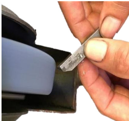
Figura 2.23. Posición del buril para segundo ángulo
