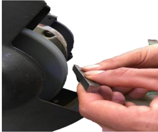
Figura 2.11. Posición de desbaste lateral izq.
