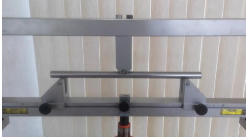
Figura 7. Ajuste de la probeta con el perno del punzón.
