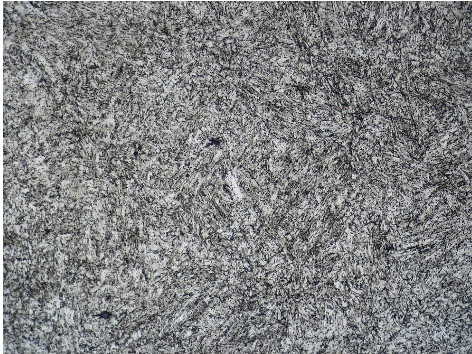
Figura 1. Martensita revenida, 500x Ataque químico con Nital al 2% .
