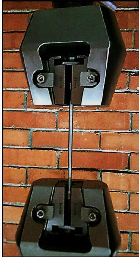
Figura 4. Probeta colocada en las mordazas.
