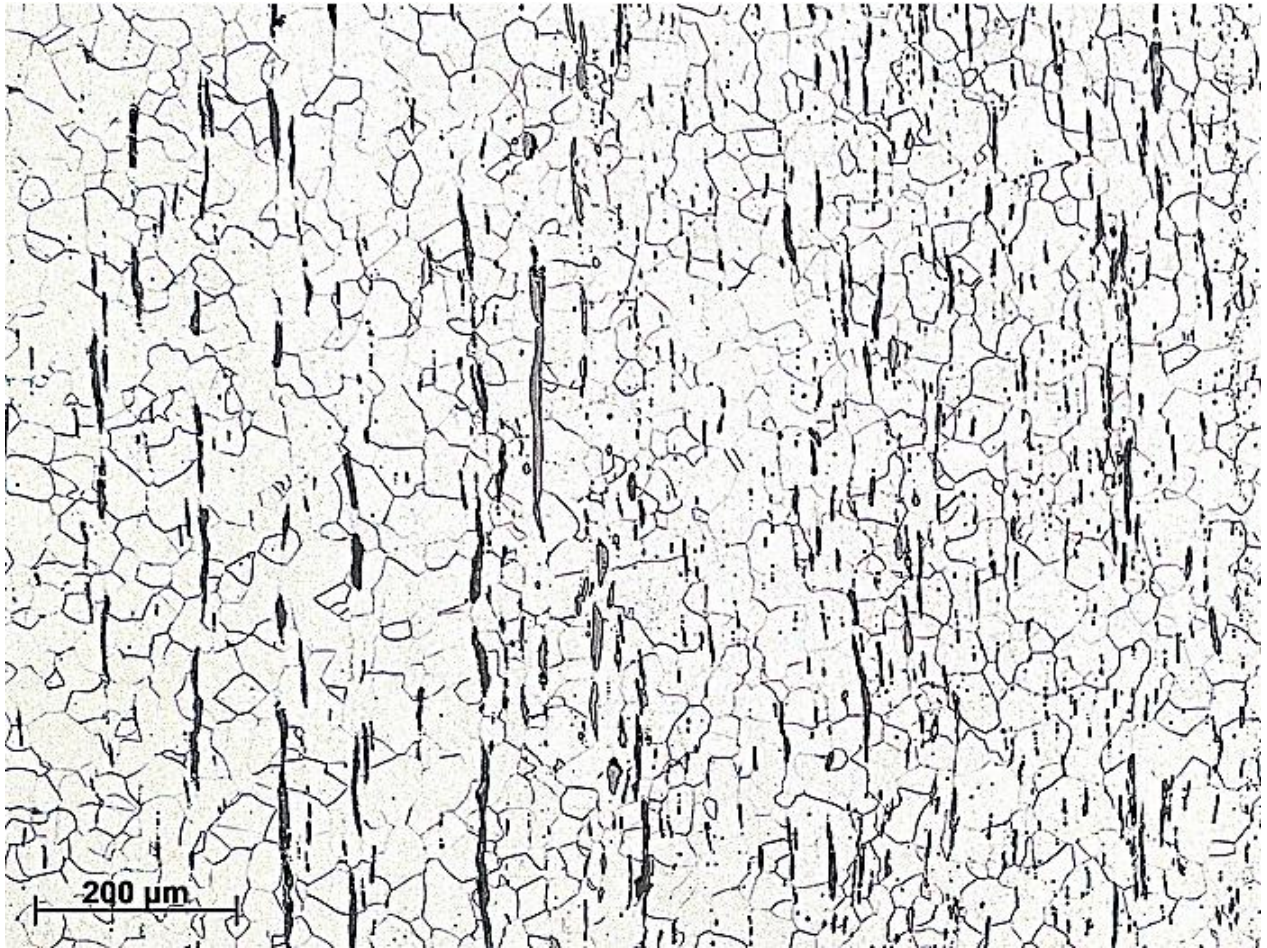
Figura 8.7. Hierro forjado, pudelado o "dulce", en donde se puede apreciar escoria alargada en una matriz ferrítica. ( https://www.ucm.es/atlasmetalografico/x29-hierro-pudelado , Universidad Complutense de Madrid)
