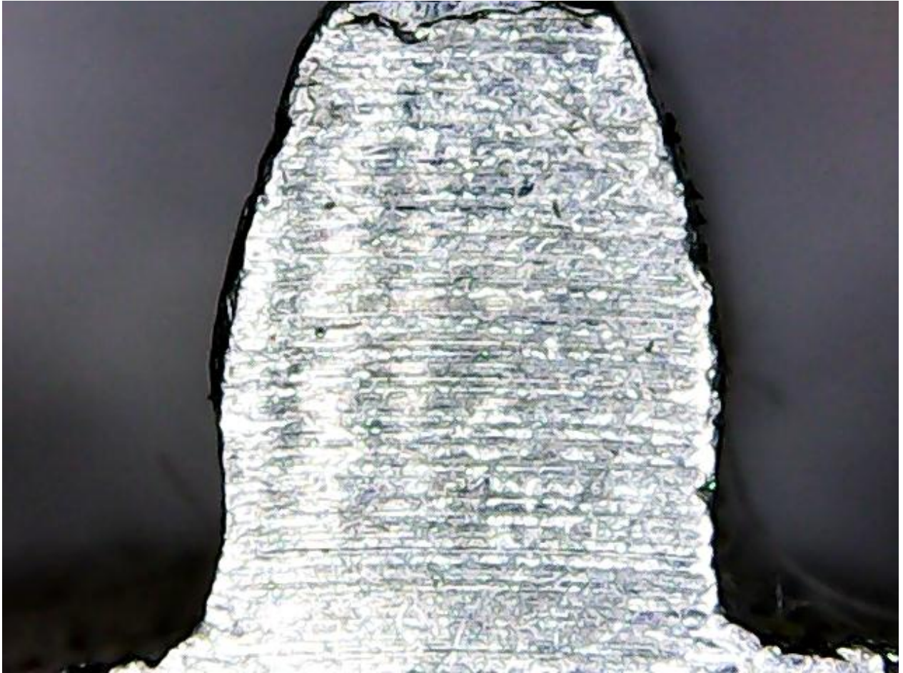
Figura 8.84. Diente de un engrane, paso diametral 20, ángulo de presión 14.5^\circ
