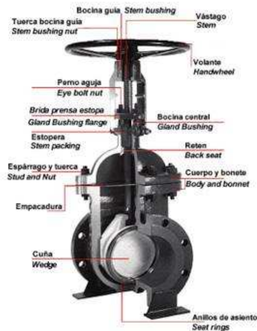
Figura 7.1. Válvula de compuerta
