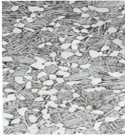
Figura 4.9. Muestra de una superaleación de titanio con cristales de fase \alpha de ambas formas.
