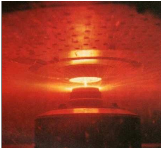
Figura 2.14. Chorro de metal fundido sobre un disco a gran velocidad, que transforma el chorro en gotitas proyectándolas a una atmósfera fría.
