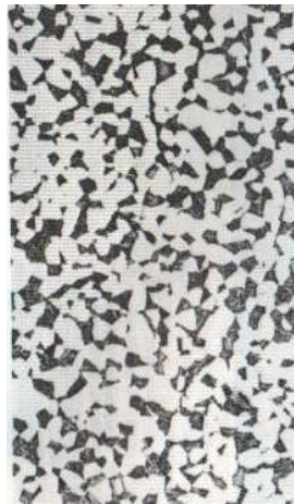
Figura 4.8. Forma esférica de los cristales de fase \alpha de las superaleaciones de titanio.
