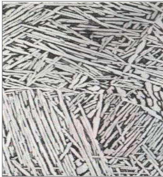
Figura 4.7. Forma lenticular de los cristales de fase \alpha de las superaleaciones de titanio.
