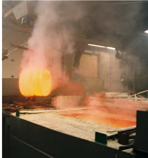
Figura 21. Horno utilizado en baños de sales.
