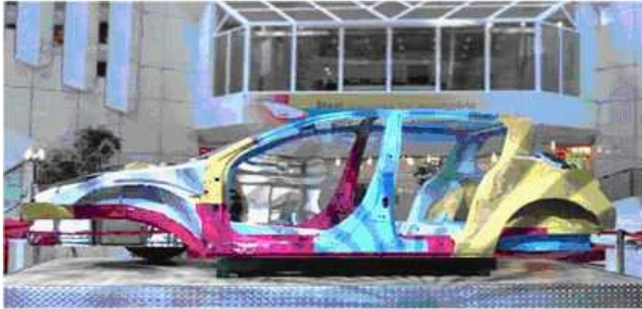
Figura 10. Carrocería para automóvil fabricada con diferentes grados de acero AHSS
