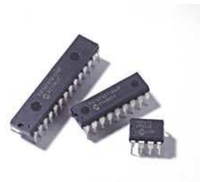
Figura 7.14. Microcontroladores PICAXE en sus diferentes tamaños
