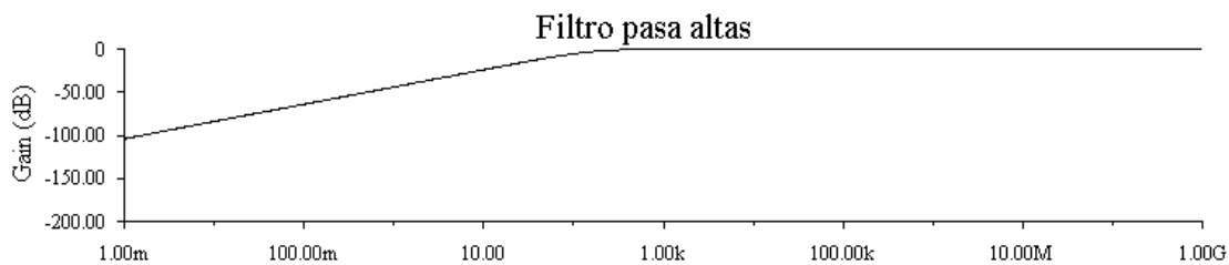
Figura 10.11. Respuesta en frecuencia en un circuito pasa-altas.
