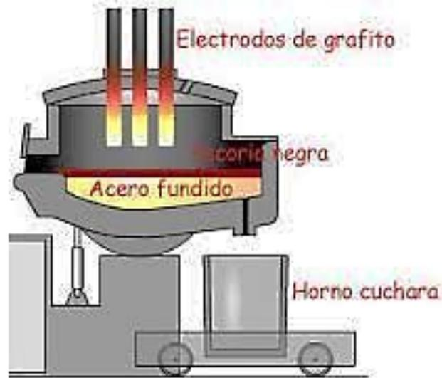
**Figura 2.23. Acero obtenido mediante arco eléctrico**
