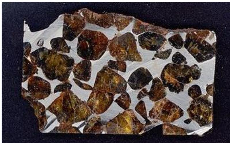
**Figura 1.1. Palasita cortada y pulida, donde se pueden apreciar los cristales de olivino en la matriz de Fe-Ni**
