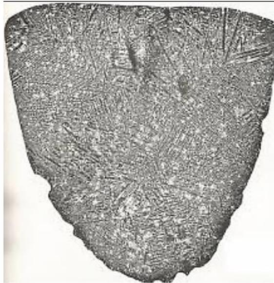
**Figura 2.5. Microestructura del acero indio Wootz utilizado para obtener las famosas espadas de acero Damasco.**
