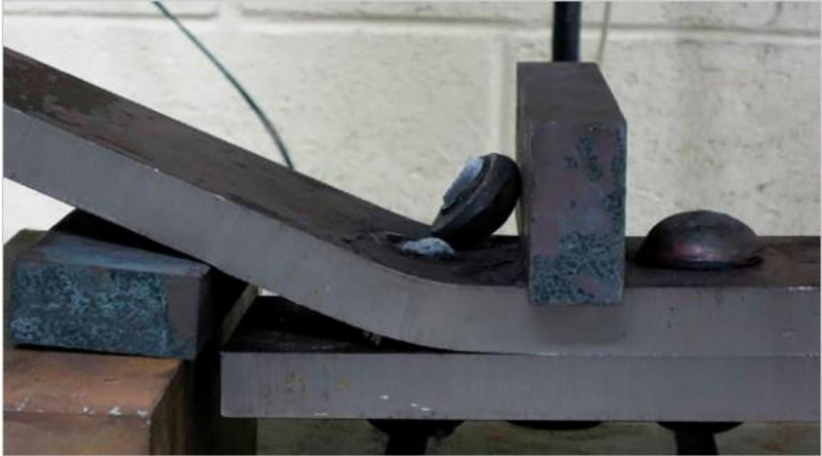
*Figura 5.9. Los remaches saltan cuando se ejerce presión sobre las placas.*
