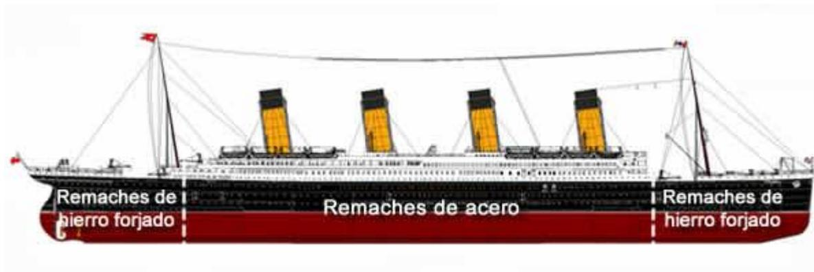
**Figura 5.7. Zonas del Titanic donde se usaron los diferentes tipos de remaches.**
