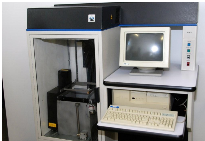
Figura 8.6. Máquina SLA-1 inventada por Charles "Chuck" Hull en 1987 y actualmente exhibida en "National Inventors Hall of Fame" de Virgina, EU. Fuente: www.3dprint.com
