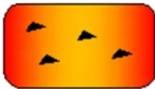
Figura 2.36. Escorias atrapadas en la pieza
