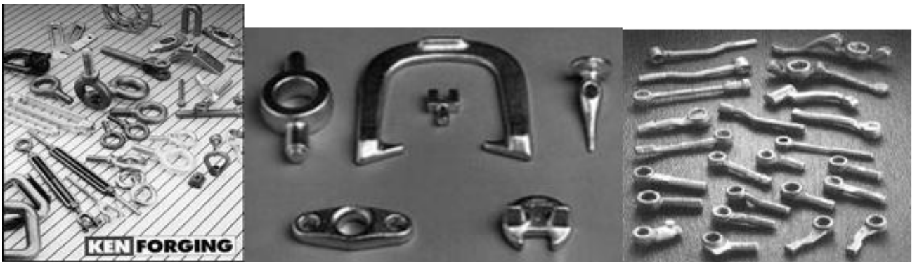
Figura 3.7. Aplicaciones de la forja en matriz cerrada.
