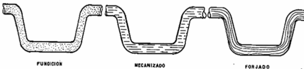
Figura 3.8. Comparación esquemática de la disposición de la estructura granular en función del proceso
