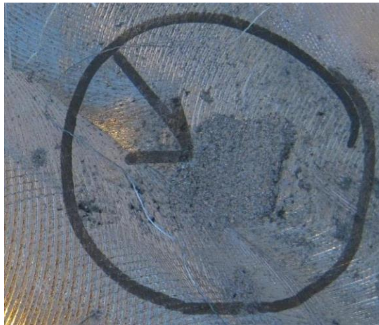
Figura 2.31. Darta en una pieza fundida
