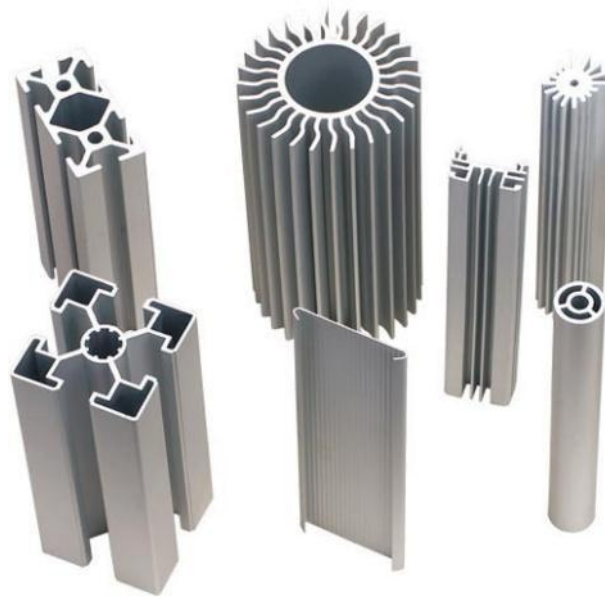
Figura 5.2. Piezas extruidas y ejemplo de productos fabricados cortados de tramos de piezas extruidas.
