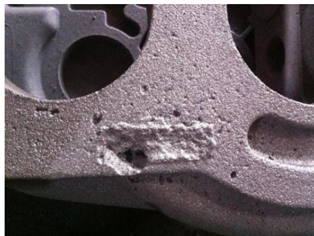
Figura 2.36. Escorias atrapadas en la pieza
