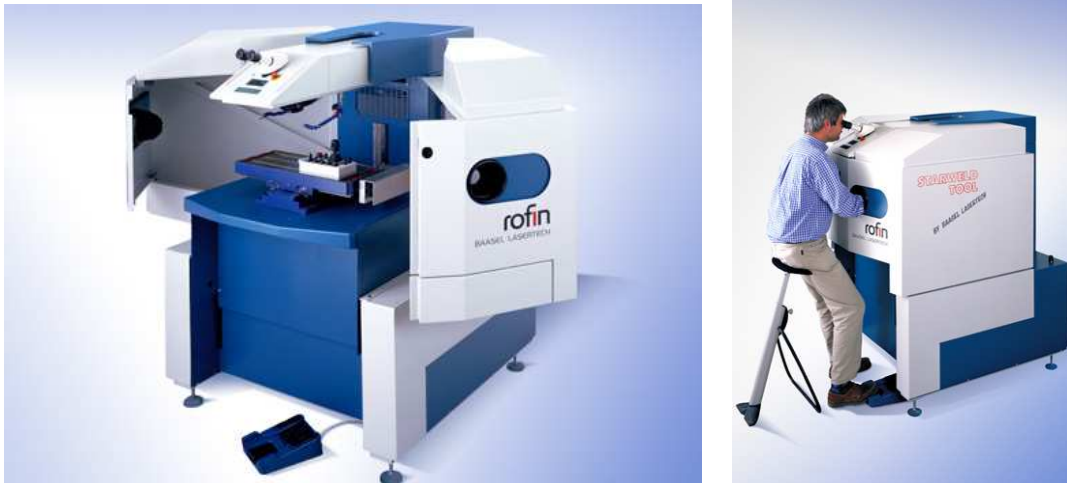
Figura 1.7. STARWELD Tool, es un láser de soldadura de Nd:YAG (estado sólido) pulsado en una cabina Clase I. El sistema incorpora una mesa motorizada en los ejes X-Y-Z y un microscopio estereoscópico.
