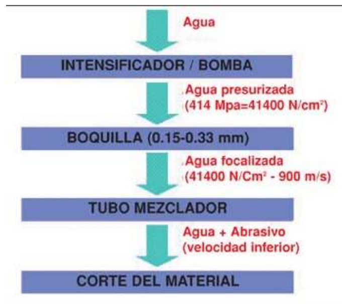
Figura 3.6.- Fases del proceso de corte por agua
