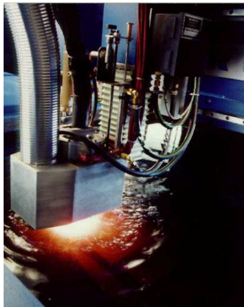
Figura 2.8. Arco protegido con agua
