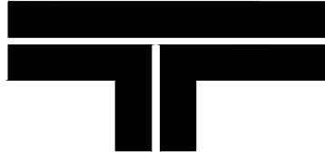
Figura 2.22.- Rayado de secciones de poco espesor
