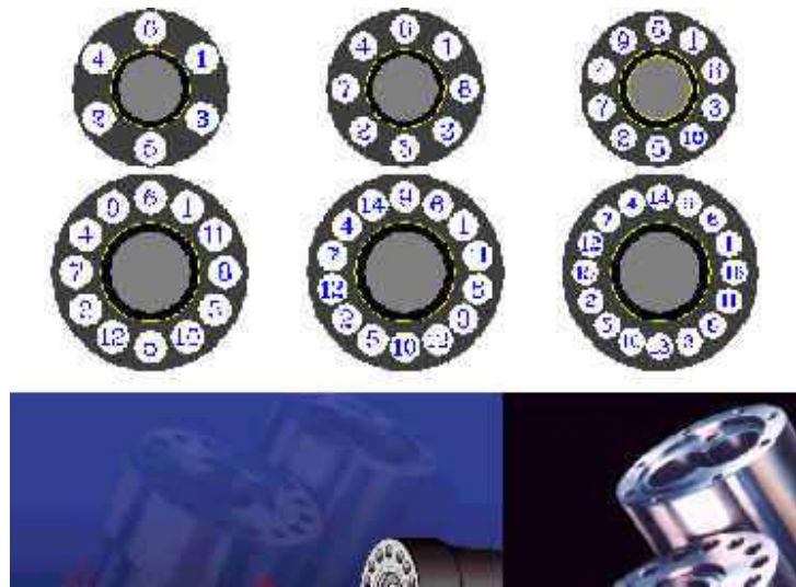
Figura 7.15.- Secuencia de apriete para la tornillería
