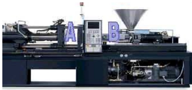
Figura 7.12.- Calentamiento del material
