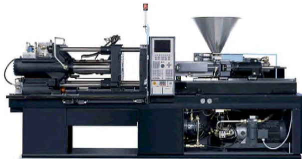
Figura 7.5.- Componentes principales de una máquina inyectora
