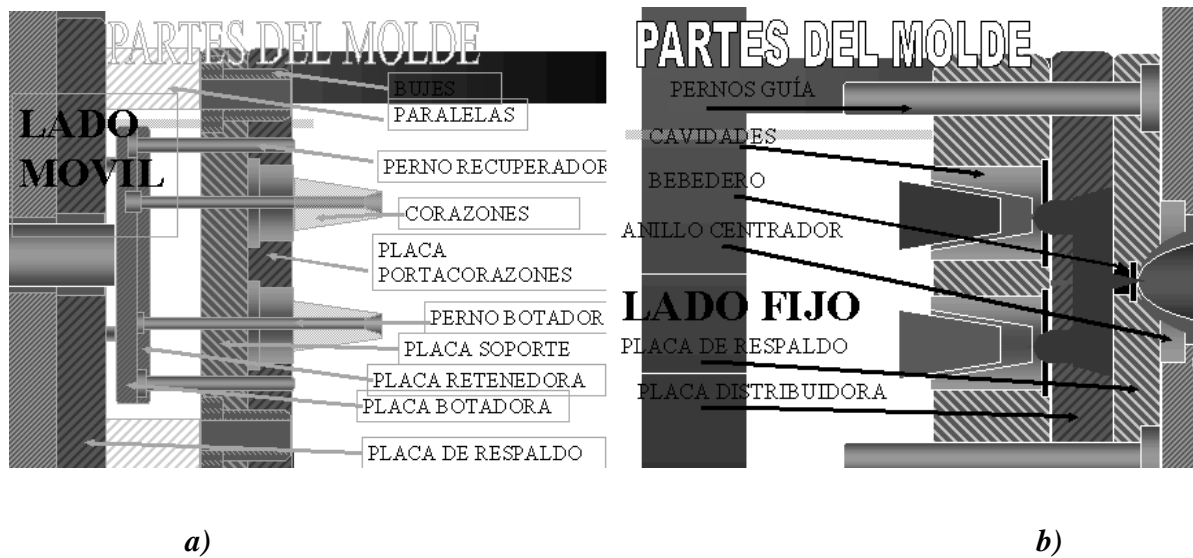
Figura 7.22.- Componentes de un molde en: a) lado móvil b) lado fijo
