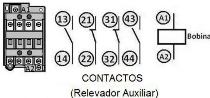
Figura 2 Relevador auxiliar y contactos.
