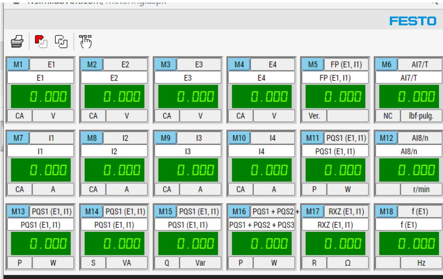
Al seleccionar, aparatos de medición, aparece una pantalla, la cual se deberá configurar cada instrumento que variable se medirá, Ca, Cd, par, velocidad, en diferente sistema de unidades. Así como el tipo de potencia, y entre que puntos.
